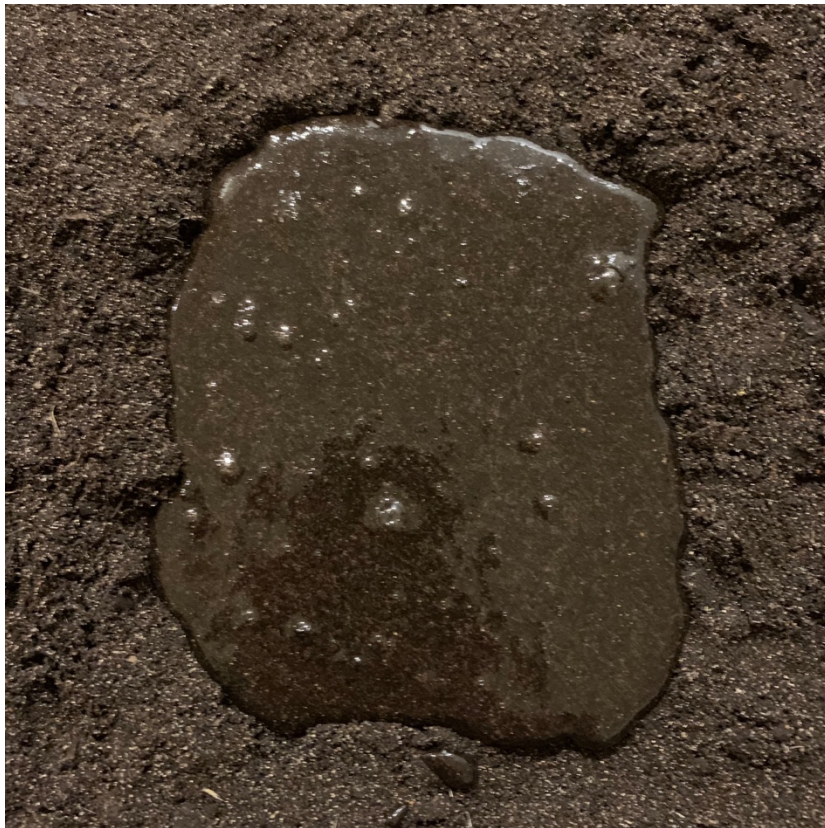
Illustratsioon 64. Kondiliimi-mulla segu džuut-armatuuriga. Autori foto.
