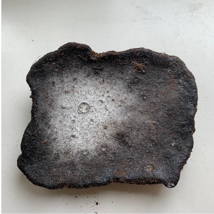
Illustratsioon 65. Kondiliimi-mulla deformatsioon. Autori foto.
