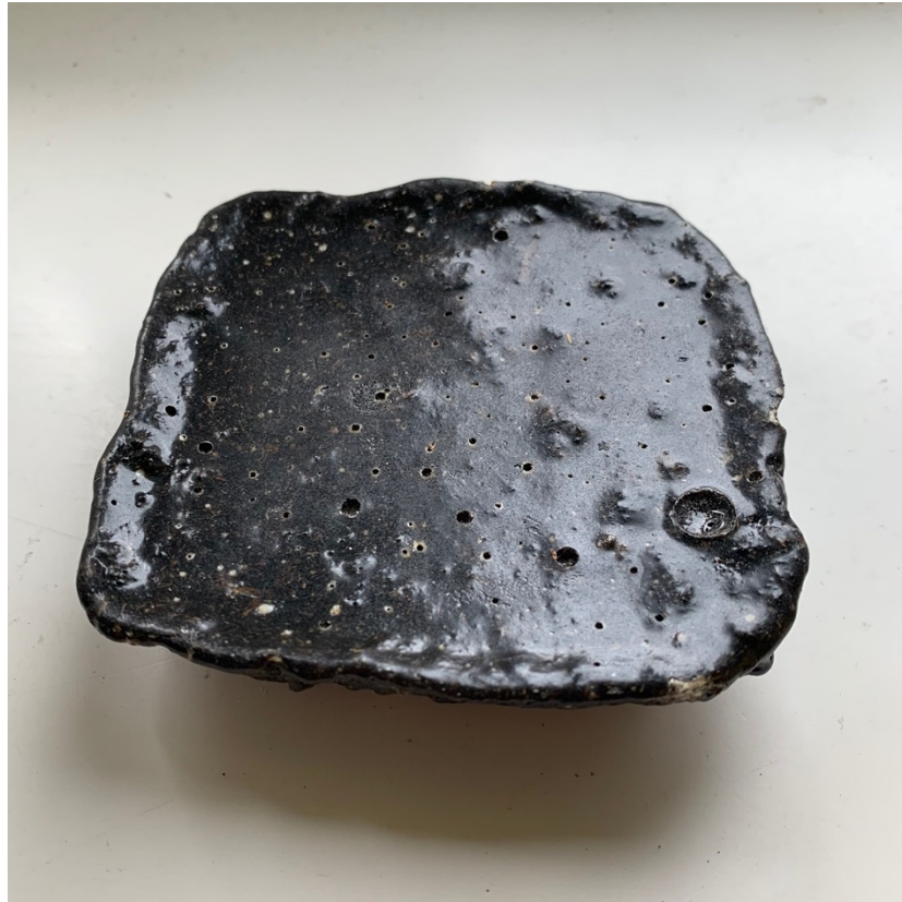
Illustratsioon 59. Kuivanud muldvaik džuut-armatuuriga. Autori foto.
