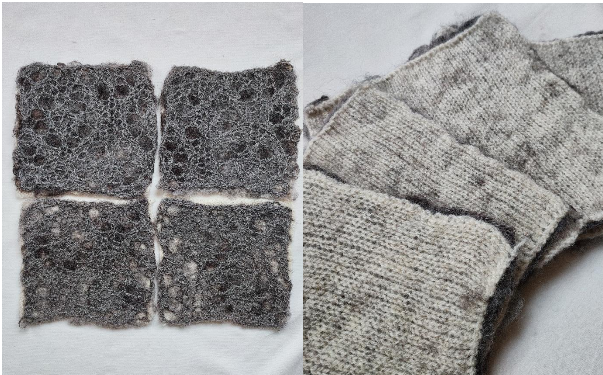
Fotod 9–10. Katsed 5.1; 5.2; 6.1; 6.2. Vasakpoolsel pildil kaks vasakpoolset näidist kootud silmuskudumisregulaatori tugevusega „3“, kaks parempoolset tugevusega „6“; Ülemine rida töötluseta, alumine rida lanoliinitöötluusega.
