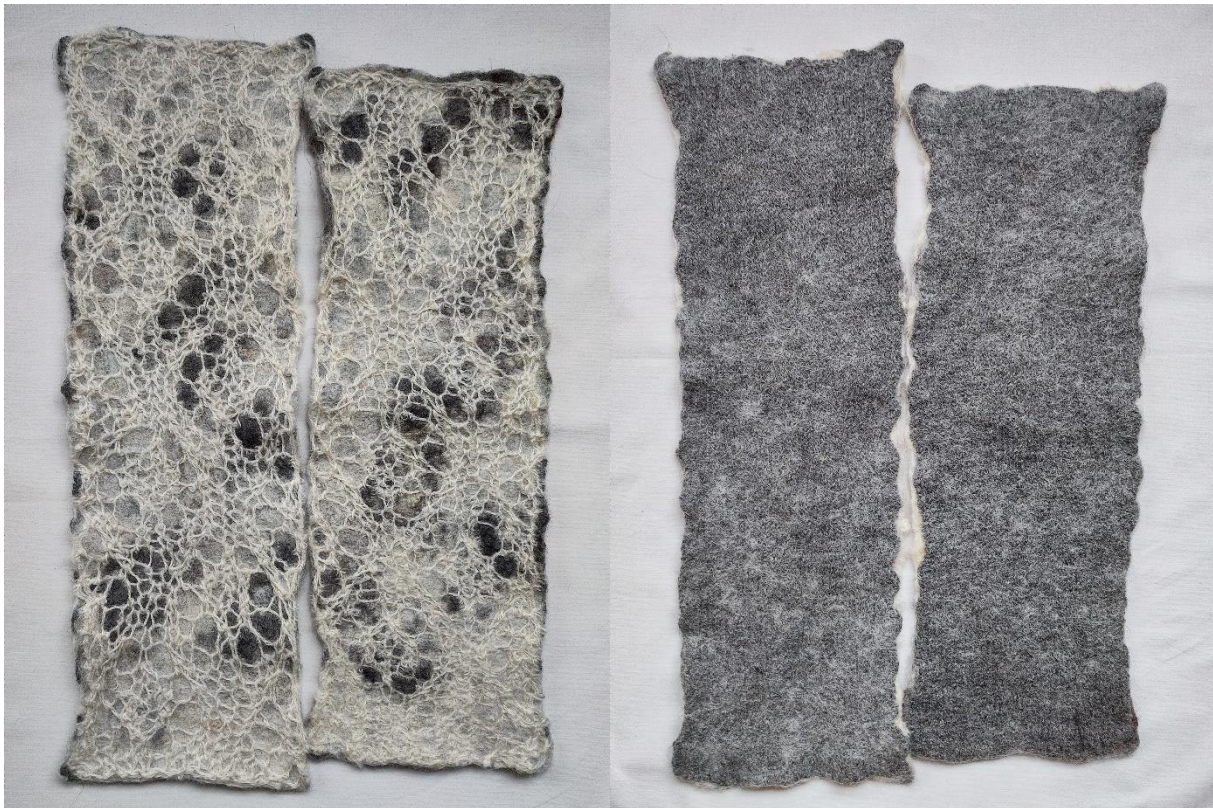
Fotod 13–16. Katsed 8.1; 8.2; 9.1; 9.2. Fotodel vasakul asetsev näidis töötluseta, paremal lanoliinitöötusega
